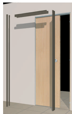
8. Colocación jambas. Fitting the doorposts. Pose du kit d'habillage.
