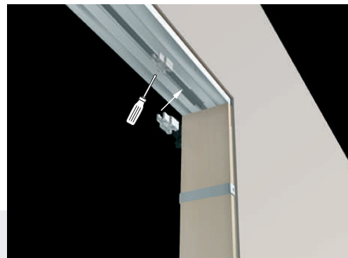
3.2 Colocación del freno. Fitting the brake. Pose du frein.
